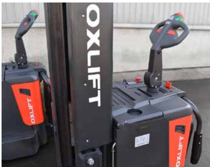
Эргономичная ручка управления с технологией CAN-BUS
