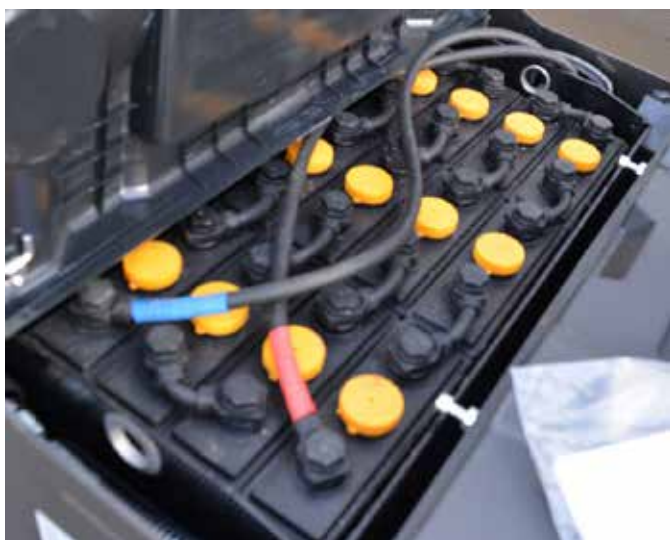
Тяговая батарея высокой емкости (350 Ач) даёт возможность работать 5-8 ч
