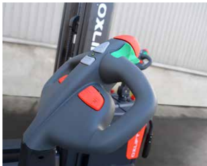
Переключатель скоростного режима («черепаха») и электромагнитный тормоз приводного колеса делают движение безопаснее
