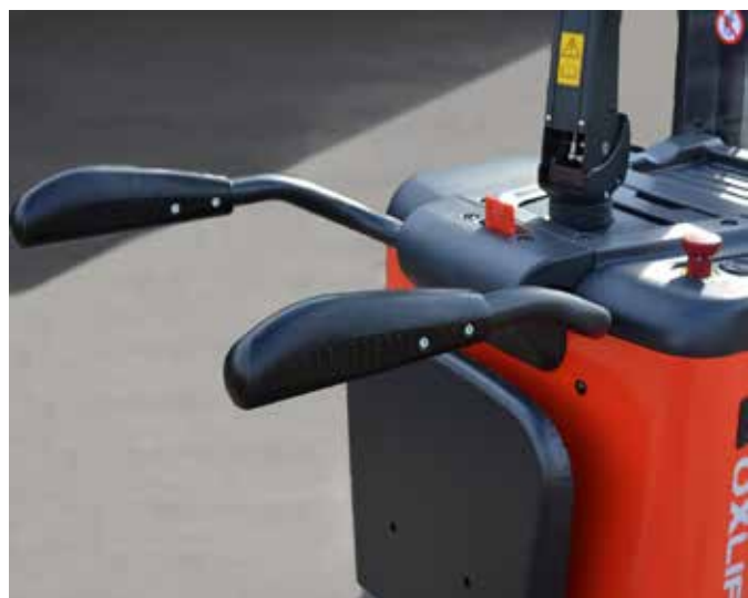
Оснащение откидной платформой и защитными поручнями для оператора
