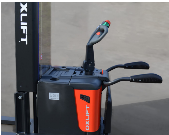
Функция электрического рулевого управления EPS (опционально)
