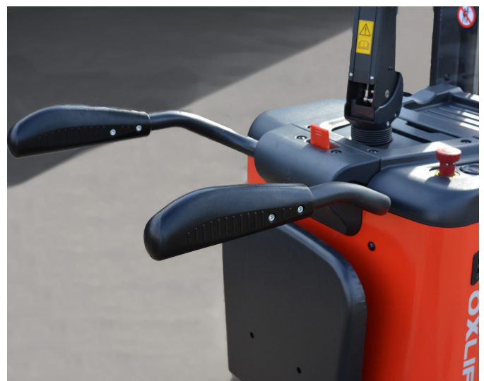
Оснащение откидной платформой и защитными поручнями для оператора
