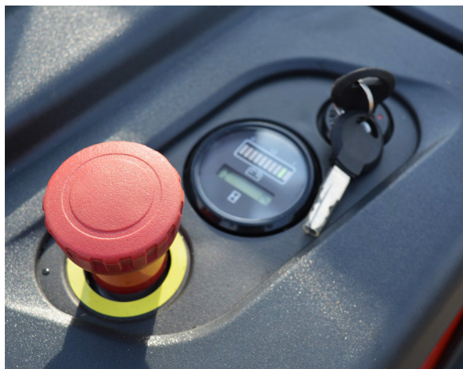
Простое, удобное управление посредством эргономичной многофункциональной ручки и панели управления с ключом зажигания, аварийной кнопкой и индикатором заряда аккумулятора
