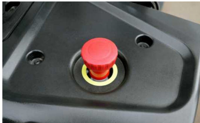
На корпусе штабелера находится кнопка аварийной остановки, что повышает безопасность при работе с паллетами.
