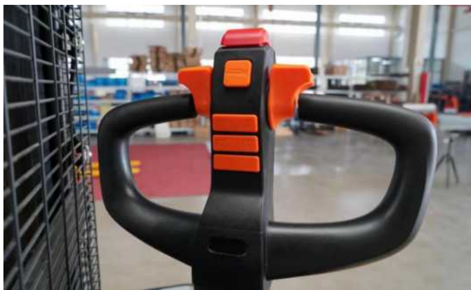
Эргономичная ручка, укомплектованная кнопками отката и звукового сигнала.
